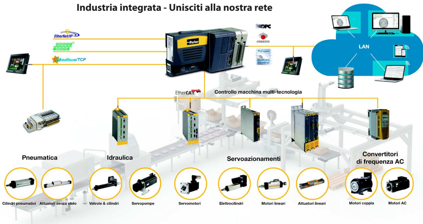
**Convertitori di frequenza serie AC30** da 0,75 a 250 kW per applicazioni di controllo del motore in anello aperto (pompe e ventilatori) e chiuso per le linee di processo.
